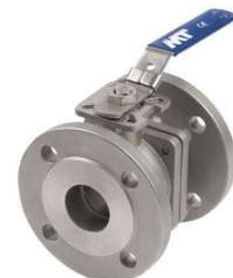
Válvula de bola bridada de dos piezas de acero inoxidable 316, paso completo sistema de bloqueo de palanca y plataforma de montaje directo.
