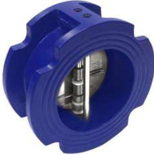
Válvula de retención doble disco de acero inoxidable 304 (DUOCHECK) cuerpo de fundición nodular, bridas EN-1092-2 PN-10/PN-16, ANSI B16.5.
