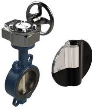
Válvula de mariposa WAFER, disco de fundición nodular recubierto en poliamida 11 (RILSAN), cuerpo de fundición nodular, asiento refaccionable EPDM, bridas EN-1092-2 PN-10/PN-16, ANSI B16.5.
