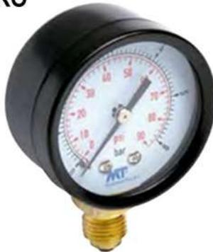
Manometro tipo Bourdon de caja seca DN 50 con conexión directa radial (inferior) de latón 1/4" NPT macho ANSI/ASME B 1.20.1.
