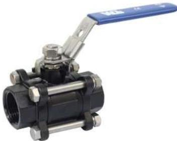
Válvula de bola de tres piezas de acero al carbon y esfera de acero inoxidable 304, paso completo sistema de bloqueo de palanca.
