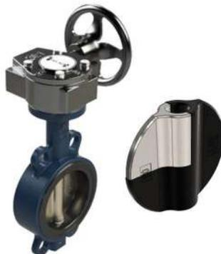
Válvula de mariposa WAFER, disco de fundición nodular recubierto en poliamida 11 (RILSAN), cuerpo de fundición nodular, asiento refaccionable NBR, bridas EN-1092-2 PN-10/PN-16, ANSI B16.5.
