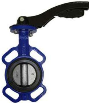
Válvula de mariposa WAFER, disco de fundicion ductil, cuerpo de fundicion gris (2" - 6") y de fundicion ductil (8" - 12"), asiento rigido, bridas EN-1092-2 PN-10/PN-16, ANSI B16.5.
