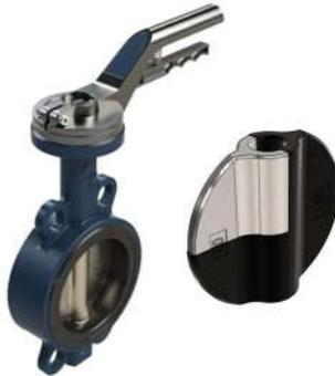
Válvula de mariposa WAFER, disco de fundición nodular recubierto en poliamida 11 (RILSAN), cuerpo de fundición nodular, asiento refaccionable NBR, bridas EN-1092-2 PN-10/PN-16, ANSI B16.5.
