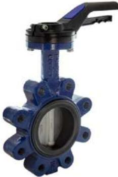
Válvula de mariposa LUG, disco de acero inoxidable 316, cuerpo de fundicion nodular, asiento refaccionable NBR
