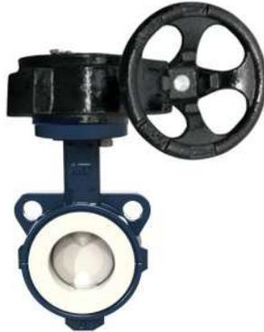
Válvula de mariposa WAFER, disco de acero inoxidable 316 recubierto de teflon, cuerpo bipartido de fundicion nodular asiento de teflon con alma de silicon, bridas EN-1092-2 PN-10/PN-16, ANSI B16.5.
