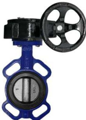
Válvula de mariposa WAFER, disco de fundicion ductil, cuerpo de fundicion gris (2" - 6") y de fundicion ductil (8" - 24"), asiento rigido, bridas EN-1092-2 PN-10/PN-16, ANSI B16.5.
