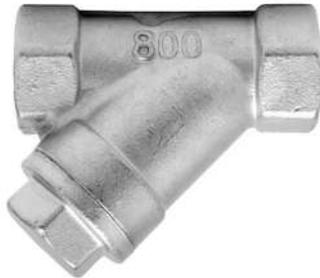
Filtro Y de acero inoxidable 316 y tamiz de acero inoxidable, paso completo grado de filtración 1mm.
