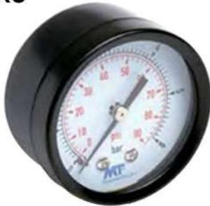
Manometro tipo Bourdon de caja seca DN 50 con conexión directa axial (posterior) de latón 1/4" NPT macho ANSI/ASME B 1.20.1.
