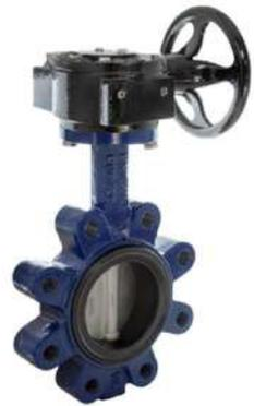
Válvula de mariposa LUG, disco de acero inoxidable 316, cuerpo de fundicion nodular, asiento refaccionable NBR
