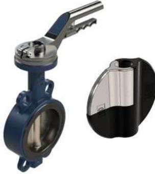
Válvula de mariposa WAFER, disco de fundición nodular recubierto en poliamida 11 (RILSAN), cuerpo de fundición nodular, asiento refaccionable EPDM, bridas EN-1092-2 PN-10/PN-16, ANSI B16.5.
