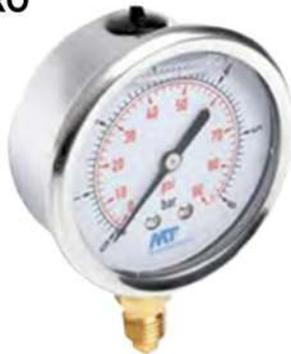
Manómetro tipo Bourdon con glicerina DN 63 con conexión directa radial (inferior) de latón 1/4" NPT macho ANSI/ASME B 1.20.1.
