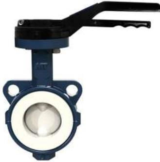
Válvula de mariposa WAFER, disco de acero inoxidable 316 recubierto de teflon, cuerpo bipartido de fundicion nodular asiento de teflon con alma de silicon, bridas EN-1092-2 PN-10/PN-16, ANSI B16.5.
